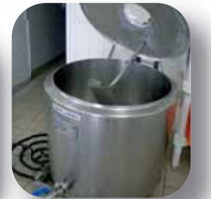
Tank à lait réaménagé en cuve de fabrication
