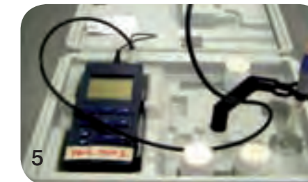
pH-mètre de type WTW 3401 avec fonction d'enregistrement
