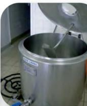
Tank à lait réaménagé en cuve de fabrication
