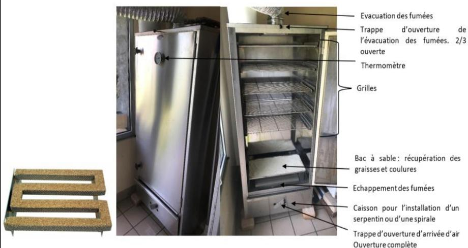
Dans un fumoir inox équipé d'une spirale de fumage remplie de sciure de hêtre. Sciure de HÊTRE HB 500/1000 Granulométrie 0.5 à 1.0 mm - Humidité 8 - 12 %
