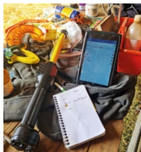
Baton de lecture de boucle : Communication bluetooth avec le smartphone ou la tablette.
