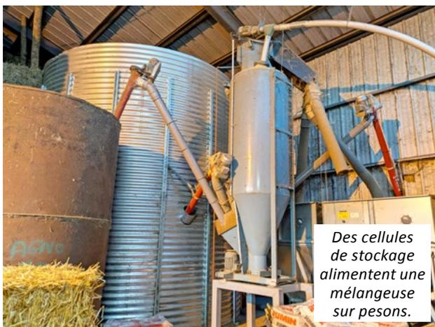
Des cellules de stockage alimentent une mélangeuse sur pesons.
