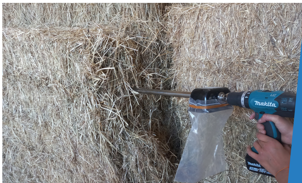
Carottage de botte de foin pour analyse
